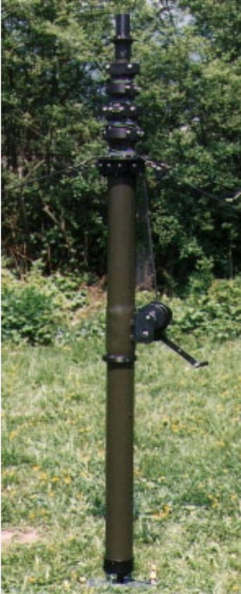
天线基本上由可伸缩的部件组成，这些部件使用复合材料，经过拉挤成型。制造过程中，通过使用纤维沿着部件经线方向安装的技术，使得部件具有极好的强度和高度的柔韧性，在拉挤成型的处理过程中，对某些玻璃纤维层进行放射状处理，使得其在直径方向上具有很高的强度。STV 天线杆完全可以符合 MIL-STD\_810 标准的要求。
